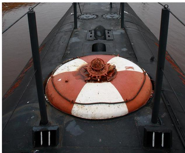
Аварийный буй – аварийный люк подводной лодки.
