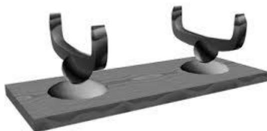
После того как шаблоны изготовлены, переносим контуры подставки на материал (древесину, фанеру, пластик и др.). Вырезаем с помощью лобзика, подгоняем, обрабатываем напильниками и наждачной шкуркой. Следующая операция – это сборка и окраска (можно покрыть морилкой), и в завершении, желательно, лакировать.
