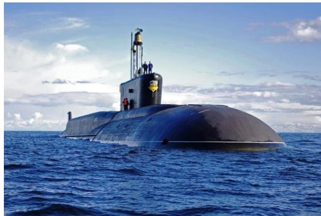
Атомная лодка имеет ядерную силовую установку (откуда, собственно, и пошло название). В наше время многие страны также эксплуатируют дизель-электрические подлодки (ПЛ). Уровень автономности атомных субмарин намного выше, и они могут выполнять более широкий круг задач.
