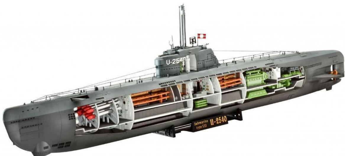
Классические двухкорпусные лодки оснащаются прочным корпусом, который на всей своей протяженности закрыт легким корпусом. Главный балласт находится в промежутке между корпусами. Лодка обладает большой надежностью, временем автономной работы, большим внутренним объемом.
